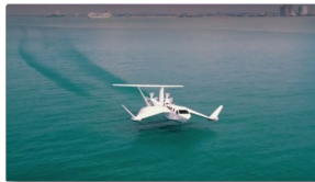
図1 シンガポールWigetworksの「Airfish 8」 ガソリン・電池の両動力エンジンも搭載する。機体サイズは全長12m×全幅15m×全高3.5m。2019年10月に秋田県の鹿角のテストフライトが実現したが、現在は運用には至っていない(出所:Wigetworks)
